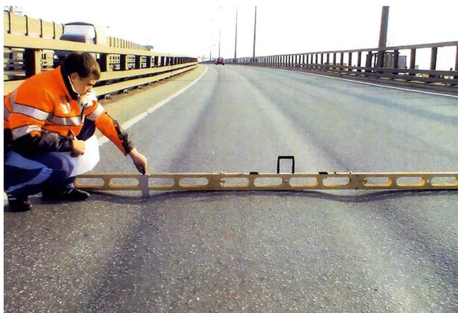
Рис. 4. Колея в левой полосе движения на кольцевой автомобильной дороге (КАД) в Санкт-Петербурге
