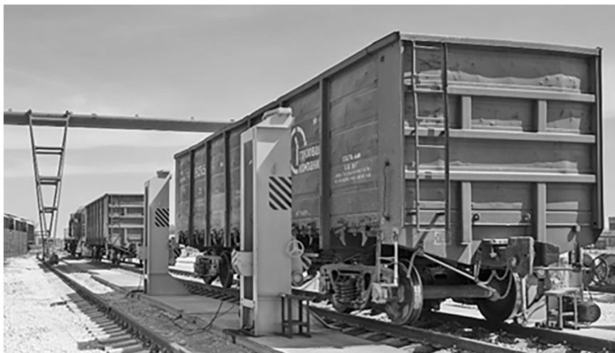
Рис. 2. Ремонт вагонов на специализированных путях текущего отцепочного ремонта
