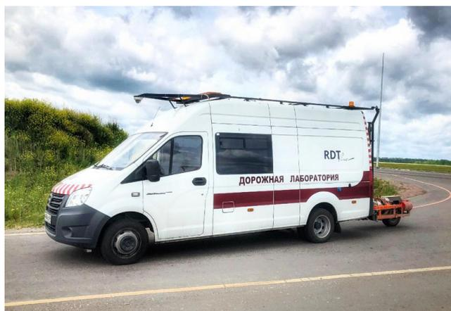
Рис. 5. Измерительный комплекс дорожной лаборатории
