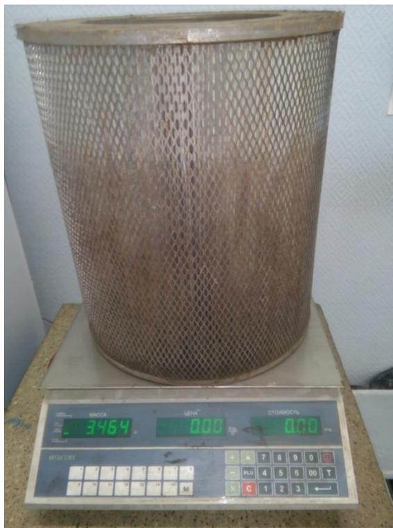
Рисунок 3.28 – Измерение массы фильтрующего элемента
