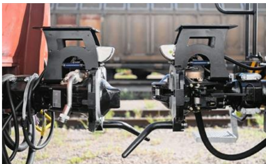
Рисунок 2.1 – Автосцепка DAC в рамках инициативы Shift2Rail
