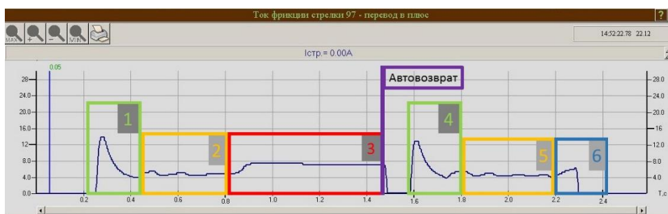
Рисунок 5.4. График изменения тока на электродвигателе в СЭП
