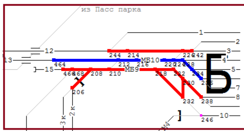
Рисунок 7.13. Схема горловины «вых. Б» ст. Челябинск гл.
