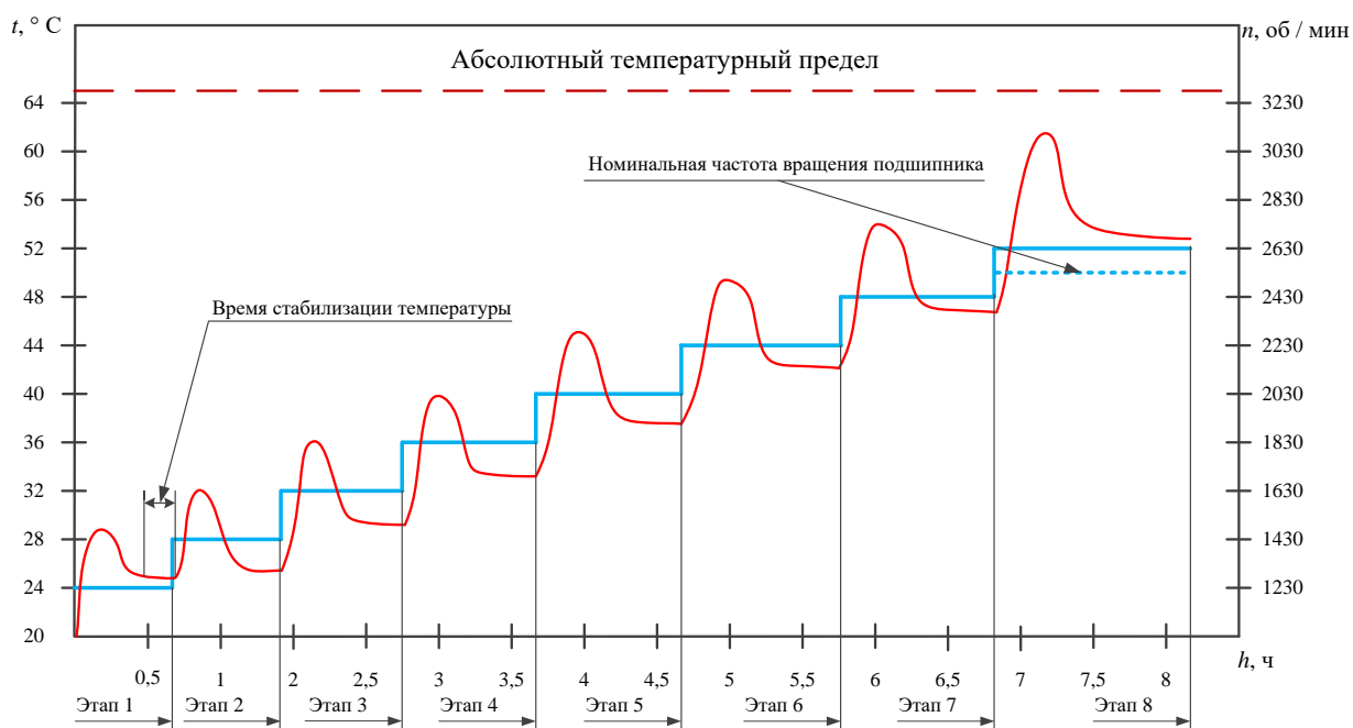
Рисунок 3.5 – График процесса приработки подшипников
