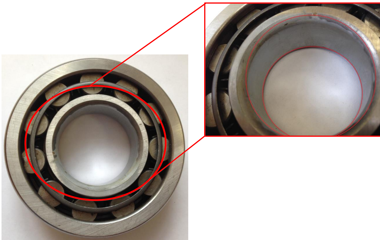
Рисунок 3.4 – Подшипник с хромовым покрытием на внутреннем кольце
