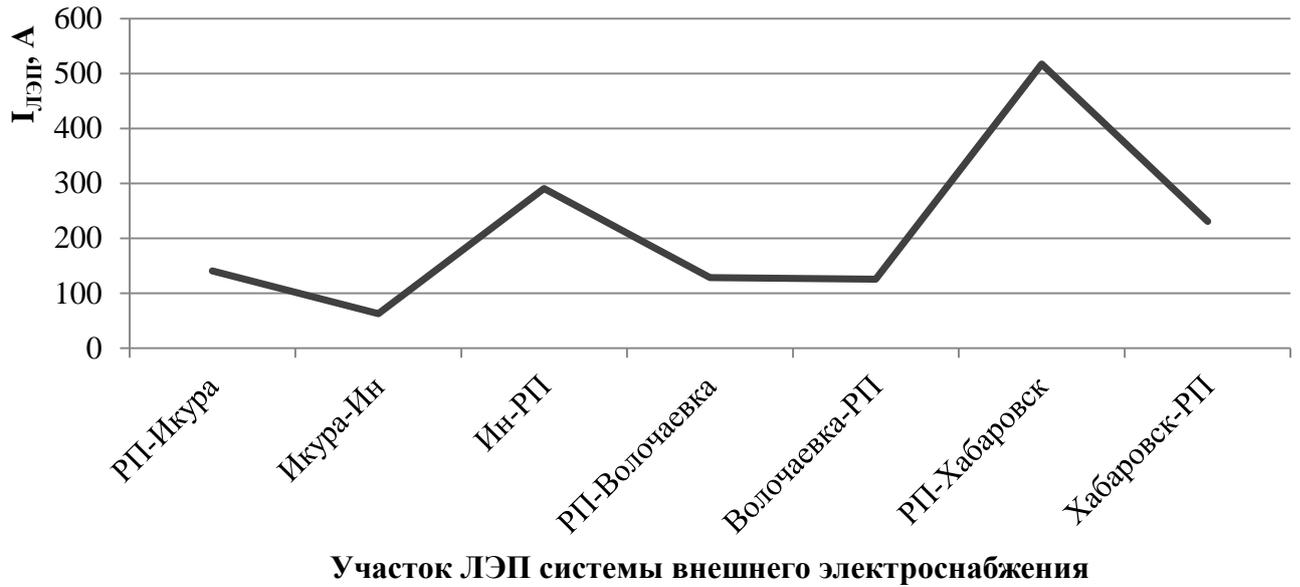
Рисунок 1.9 – Наибольшие токи в ЛЭП с проводами АС-300
