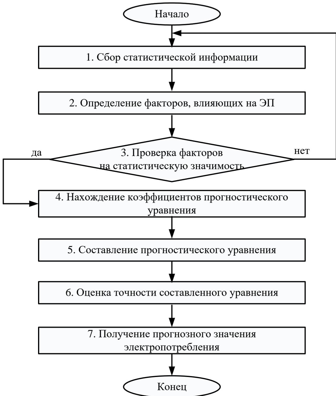
Рисунок 2.11 – Блок-схема алгоритма прогнозирования ЭП
