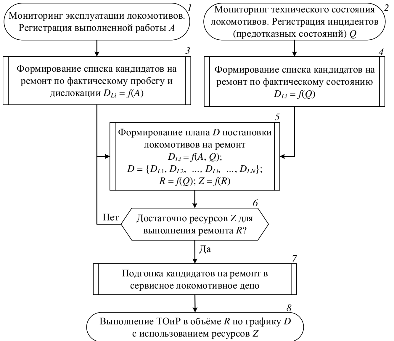
Рисунок 3.13 – Алгоритм оперативного планирования постановки на ТОиР
