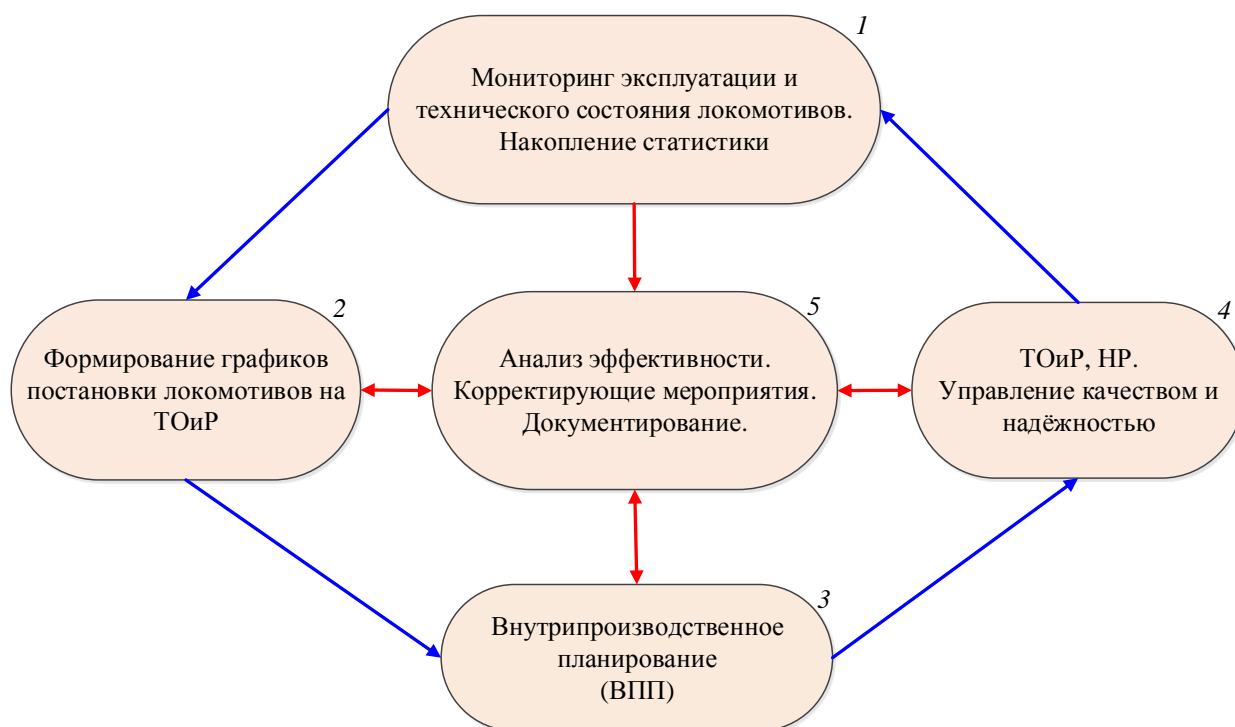
Рисунок 2.3 – Базовые функциональные подсистемы информационно-динамической модели управления сервисным обслуживанием и ремонтом локомотивов (модели)
