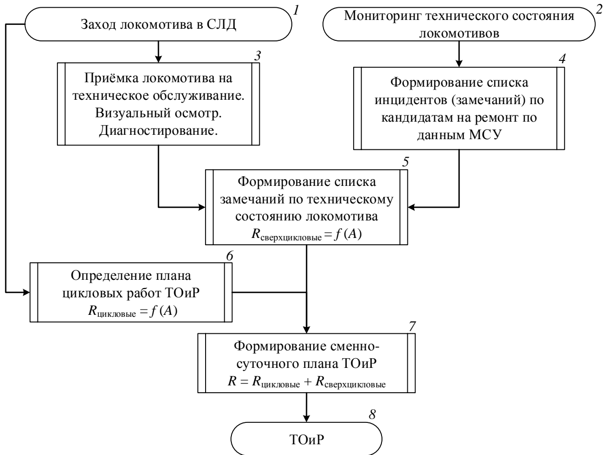
Рисунок 3.14 – Алгоритм приёмки локомотива на ТООР
