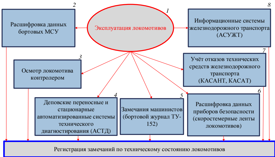
Рисунок 1.11 – Регистрация замечаний по техническому состоянию локомотивов для дальнейшего определения объёма сверхцикловых работ
