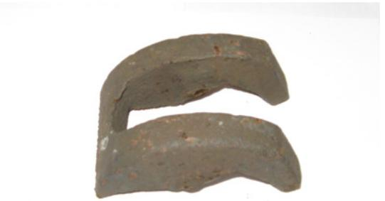
Рисунок 1.1 – Последствия прохода отцепов через деформированный горб горки<sup>2</sup>:
