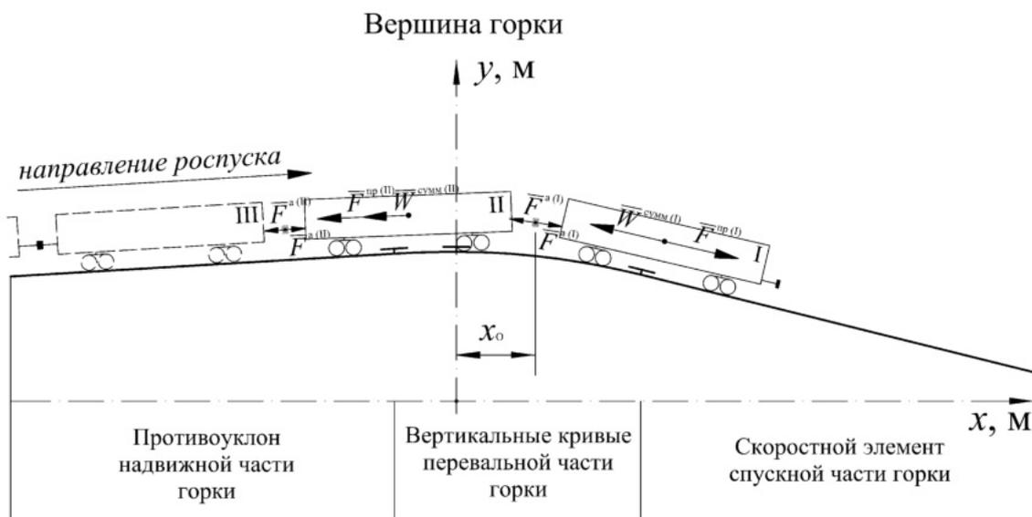
Рисунок 2.7 – Расчетная схема для определения положения отцепы, состоящего из одиночного вагона, в момент его отрыва от состава при наличии сил  $F^a$
