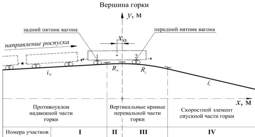
Рисунок 2.1 – Схема к определению уклонов под пятниками вагона на участках продольного профиля горба горки
