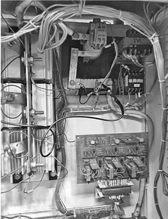
Рис. 2. Подключение осциллографа к измерительному шунту амперметра диагностического стенда
