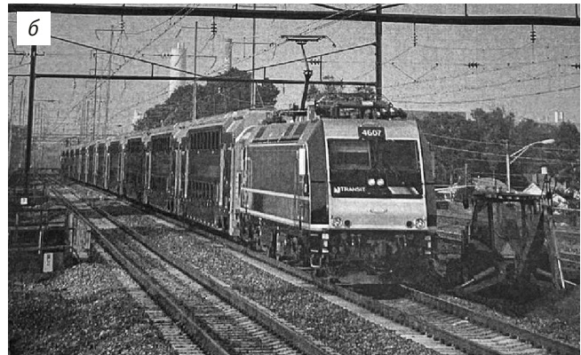
Рис. 1. Локомотивы с установленными на крыше токоприемниками полупантографного вида:
