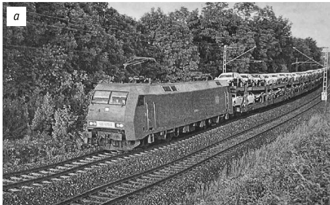
Рис. 1. Локомотивы с установленными на крыше токоприемниками полупантографного вида:
