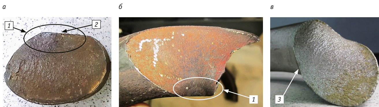
Рис. 1. Поверхности изломов витков наружной надбуксовой пружины рессорного подвешивания тележки пассажирского вагона
