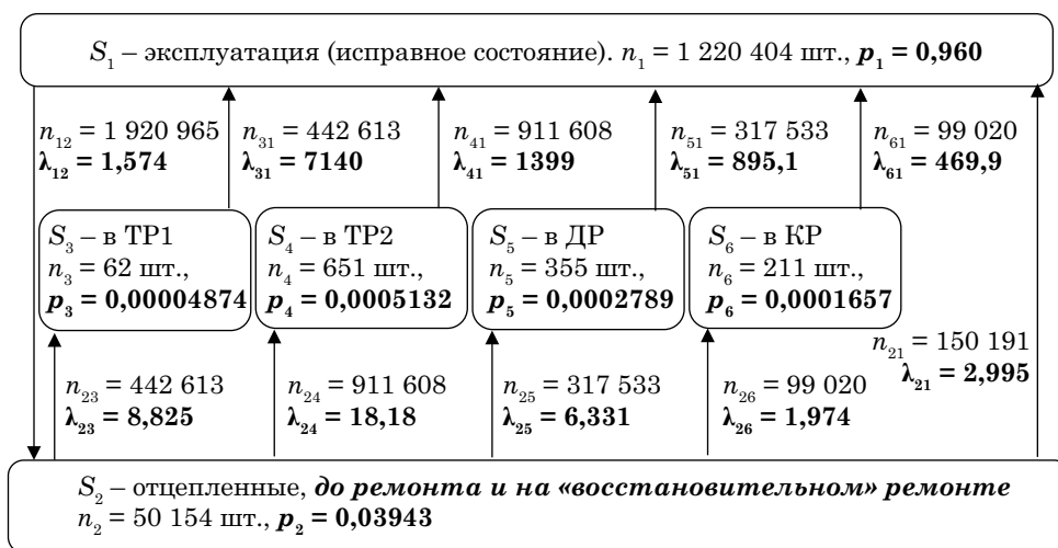
Рис. 4. Модель системы ТОиР грузового вагона с выделением состояний непосредственного проведения работ
