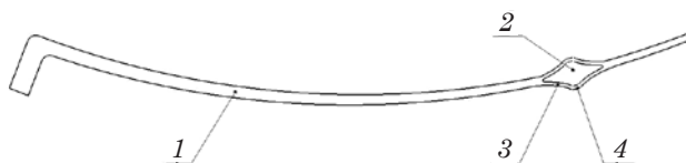
Рис. 11. Конструкция чеки колодки грузового вагона с пружинным замком: 1 – основное тело тормозной чеки; 2 – пружинный замок; 3 – выпуклая наружу пластина; 4 – упорная поверхность
