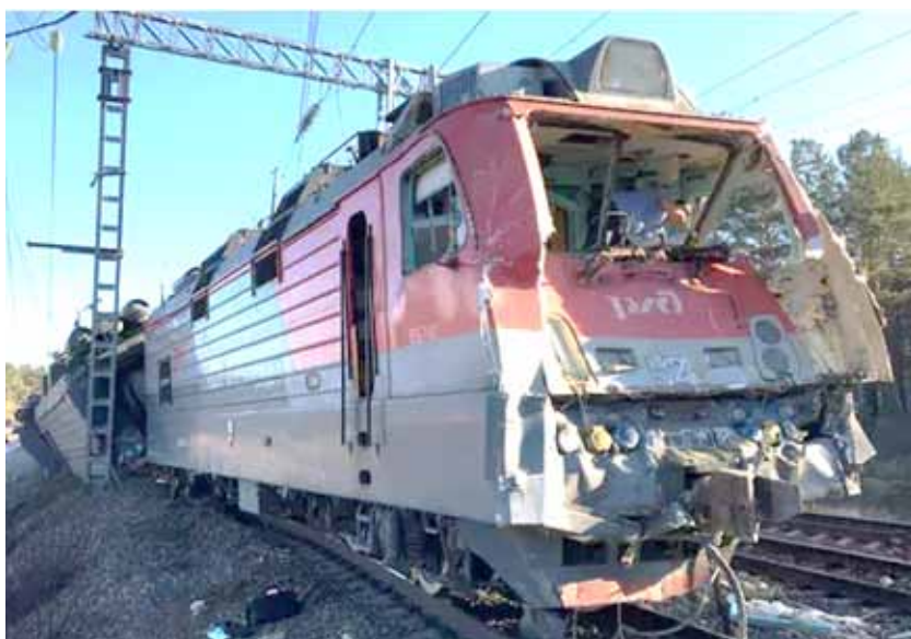
Рис. 1. Последствия столкновения локомотива с грузовым автомобилем
