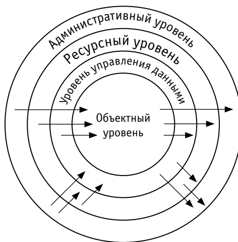
Рис. 2. Функциональная схема цифровой модели СТОР грузовых вагонов
