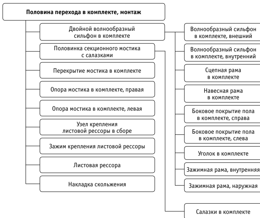
Рис. 2. Структура монтажных узлов половины УМВП
