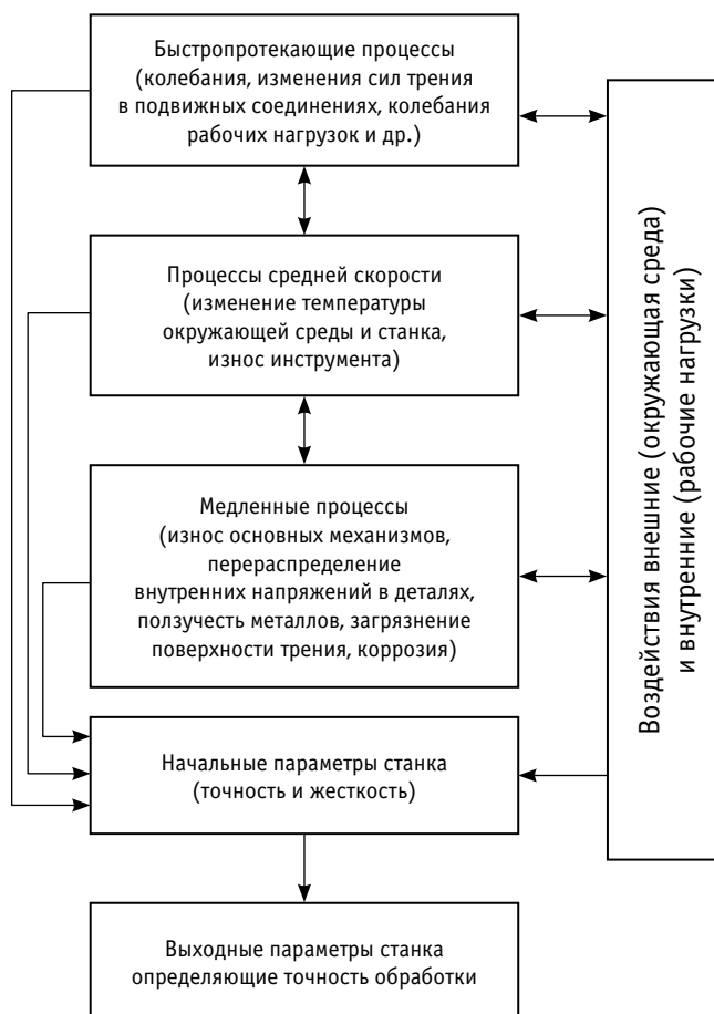
Рис. 1. Схема образования выходных параметров процесса обработки осей колесных пар
