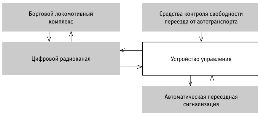
Рис. 6. Структурная схема системы управления АПС по оценке тормозного пути
