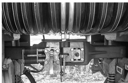
Рис. 5. Внешний вид беззазорного сцепного устройства в сцепленном состоянии
