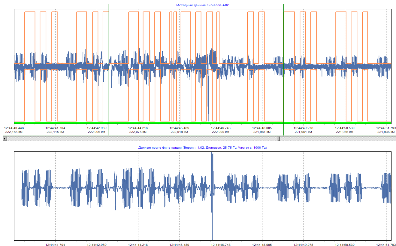
Рис. 6. Импульсные помехи в рельсовых цепях на участке А–Б
